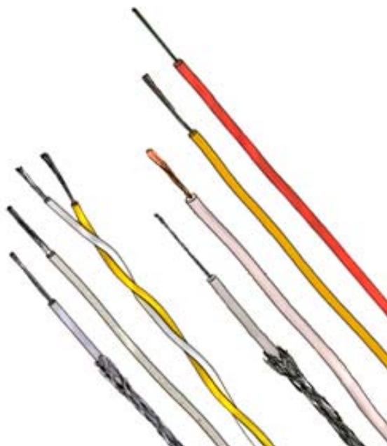
МНВ - малогабаритные низковольтные провода для монтажа методом накрутки или пайки для работы при рабочем переменном напряжении до 100В частоты до 10 кГц.
