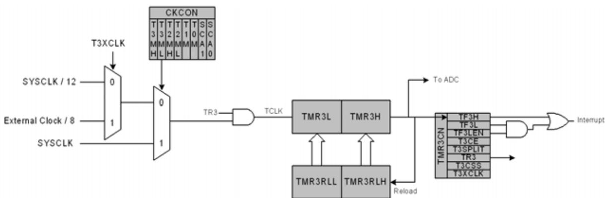
Figure 21.8. Timer 3 16-Bit Mode Block Diagram
